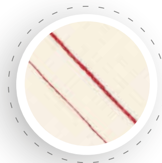
Dubbele kettingsteeknaad voor het samennaaien van zeer stevige materialen, voor siereffecten
