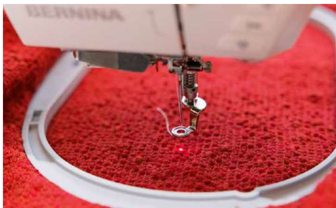
Exacte plaatsing dankzij de pinpointlaser
